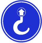
An allen Maschinen sind die Anschlagpunkte zum Anheben mit dem dargestellten Symbol gekennzeichnet.
