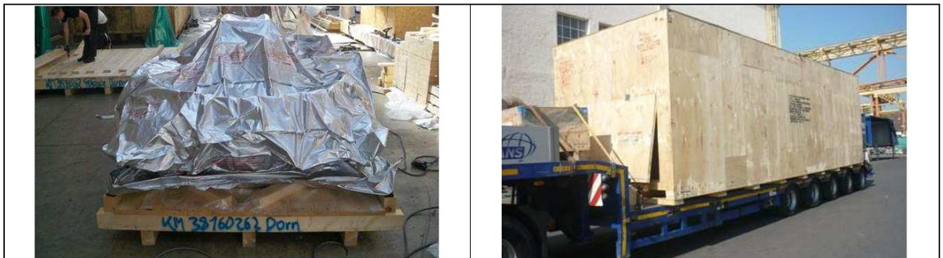
Las piezas se embalan en capa de sellado (lámina compuesta de aluminio) con desecante y se unen al fondo; los laterales y la tapa de madera se ensamblan.
