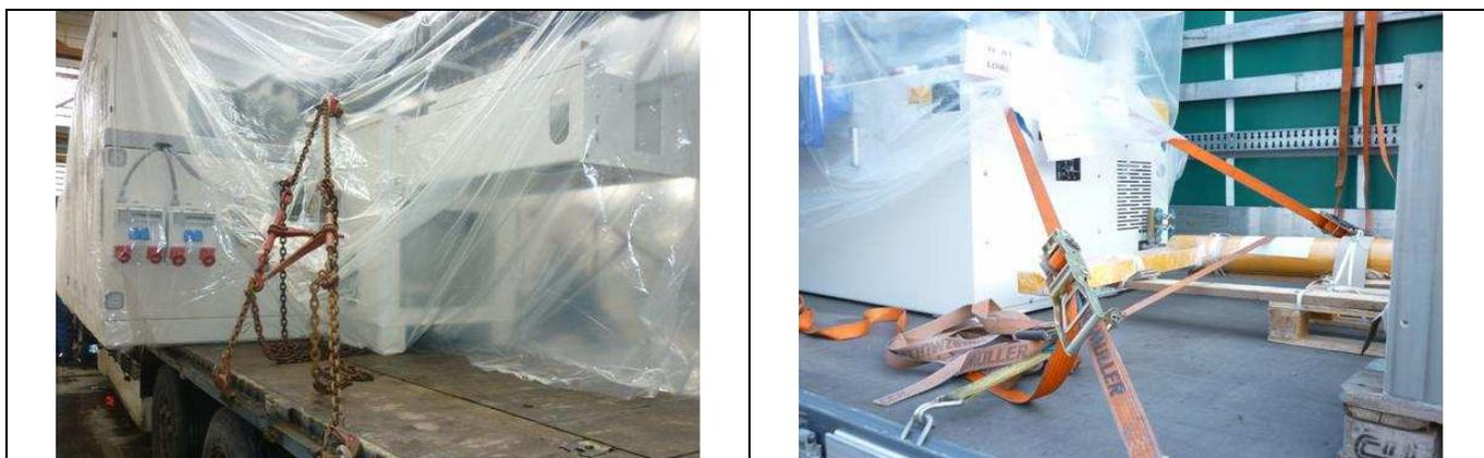
Las máquinas se cargan en un camión, sin embalar y envueltas en una lámina de protección contra el polvo.
