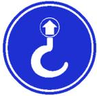
En todas las máquinas están marcados los puntos de elevación para izar la carga con el símbolo representado.
