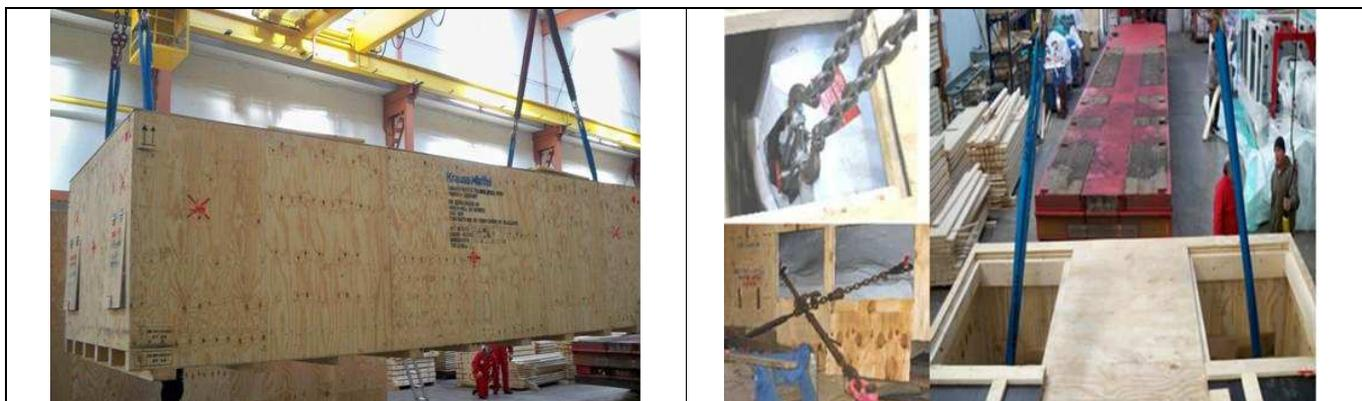
El embalaje es solamente "arrastrado": los puntos de elevación se encuentran en la máquina. / **Importante:** es imprescindible volver a cerrar las tapas de la lámina y de la caja.
