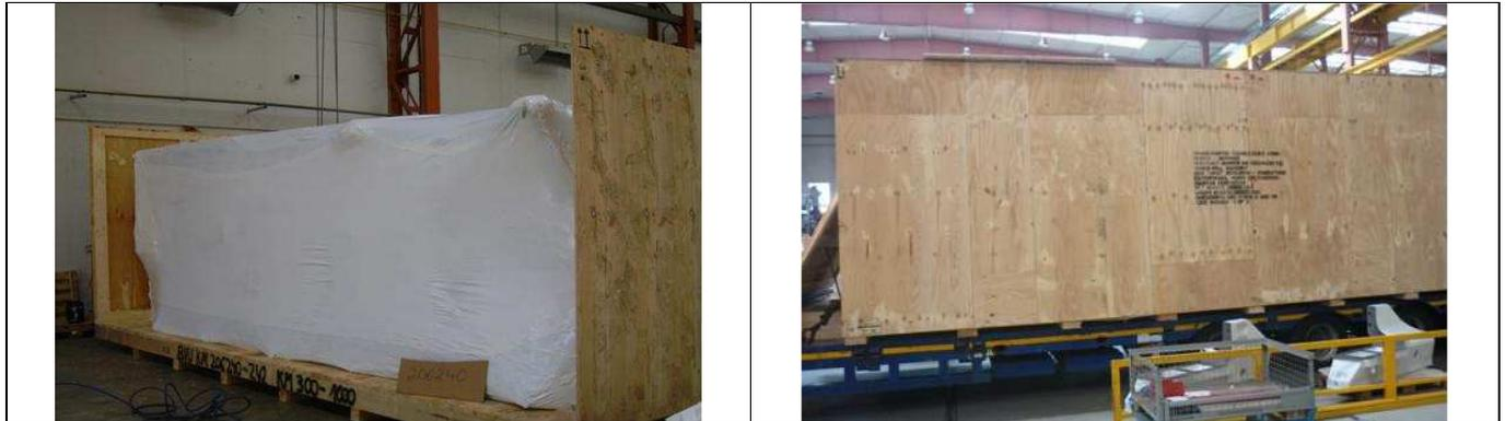
Piezas envueltas en lámina de conservación VCI y en lámina de PE retráctil y unidas al fondo; los laterales y la tapa de madera se ensamblan.
