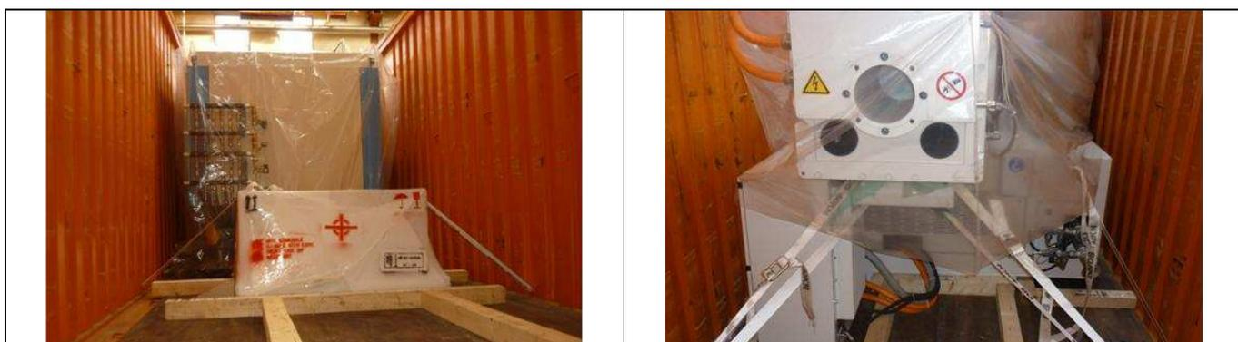
Las máquinas se tratan con grasa de conservación y se colocan en el contenedor envueltas en una cubierta de protección contra el polvo.
