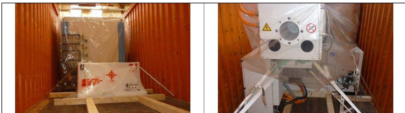
Машины консервируются с помощью смазки, устанавливаются в контейнер и накрываются тентом для защиты от пыли
