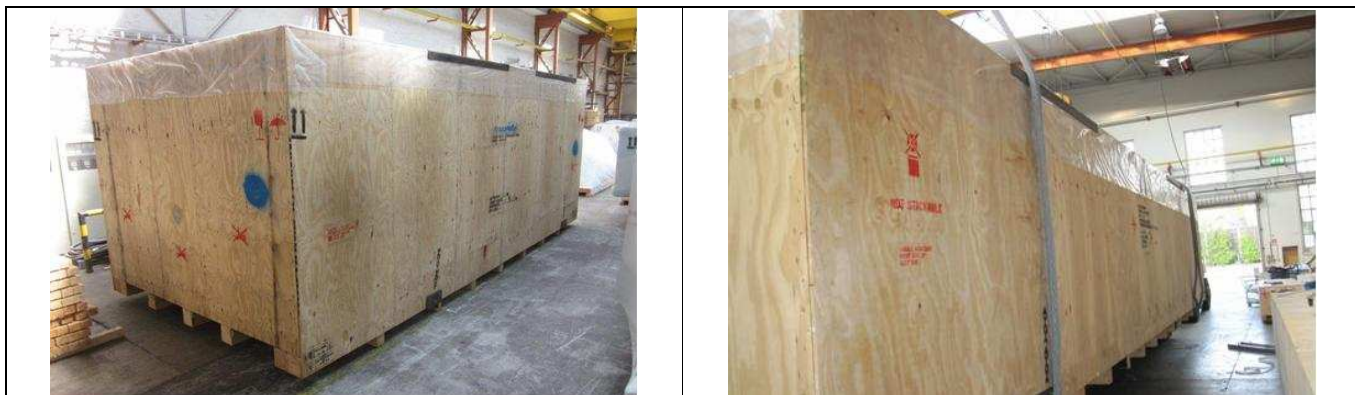
Транспортировочный ящик – точки строповки расположены снаружи на ящике
