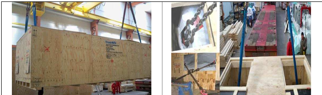
Упаковка только "обхватывает" машину – точки строповки расположены на самой машине! / Важно: Клапаны на пленке и ящике должны быть обязательно закрыты!
