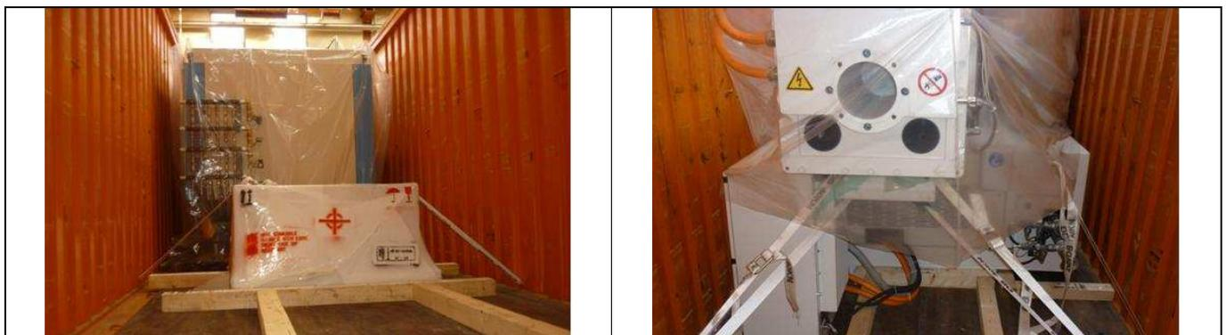
Le macchine vengono protette mediante applicazione di uno strato di grasso e stivate nei container con un telone antipolvere.
