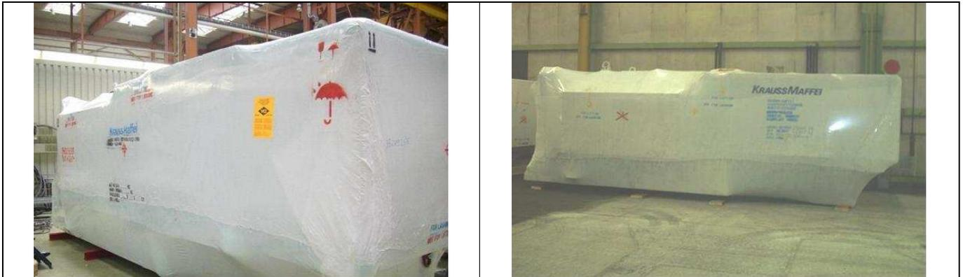
I pezzi vengono rivestiti con un film plastico VCI per la conservazione del materiale ed avvolti con una pellicola in PE termoretraibile.
