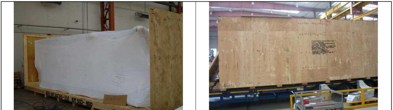
I pezzi vengono rivestiti con un film plastico VCI per la conservazione del materiale ed avvolti con una pellicola in PE termoretraibile. Sono quindi fissati ad un fondo in legno, al quale vengono collegati pareti e coperchio in legno.
