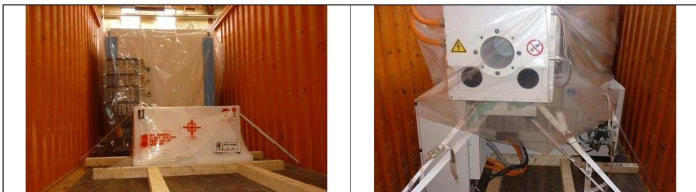
Les machines sont protégées dans de la graisse et arrimées dans un container avec une bâche de protection.
