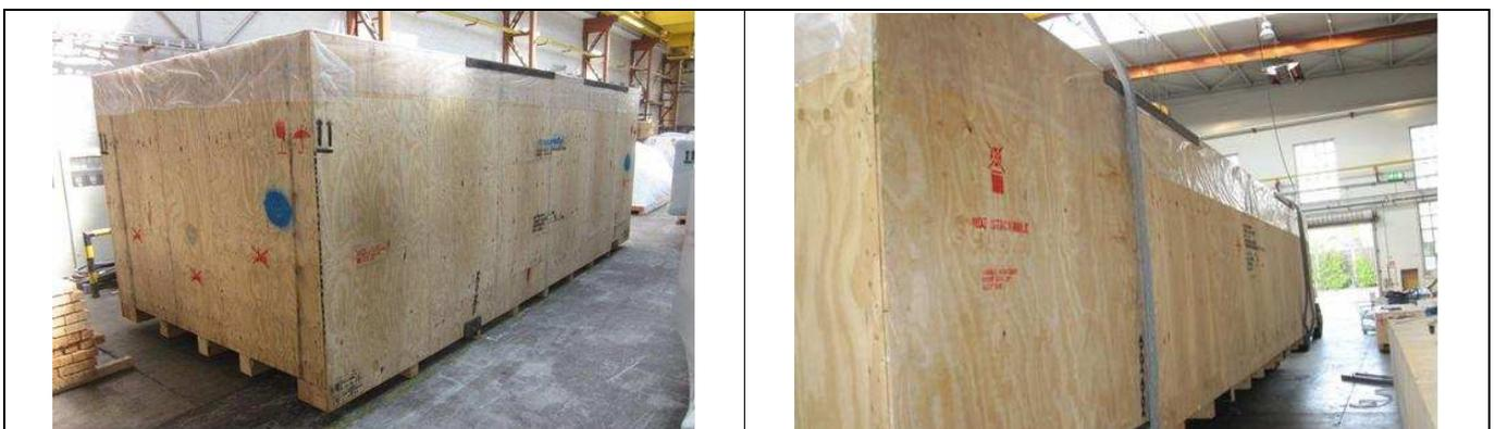
Caisse de transport porteuse – points d'élingage à l'extérieur sur la caisse.
