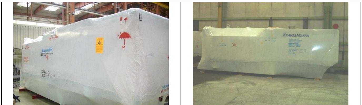
Pièces enveloppées dans une feuille VCI de conservation et emballées sous film PE rétractable.
