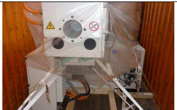
Machines worden met vet geconserveerd en met stofbeschermeel in container opgeborgen.
