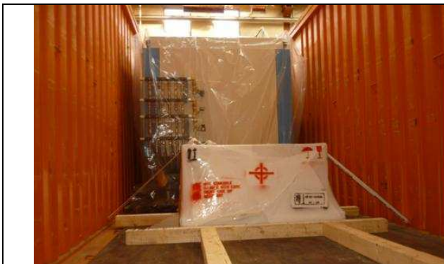
Machines worden met vet geconserveerd en met stofbeschermeel in container opgeborgen.
