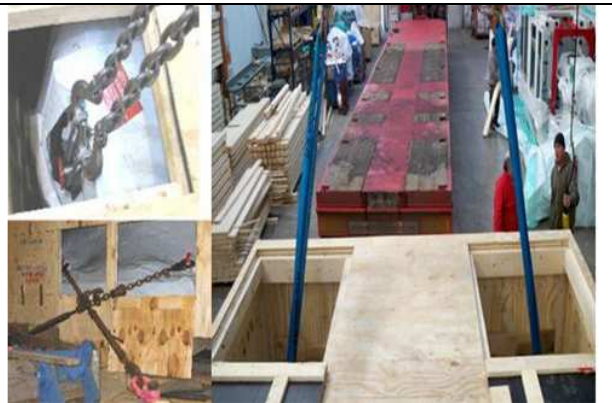
Verpakking wordt alleen "meegenomen" – aanslagpunten zijn aan de machine! / Belangrijk: kleppen aan de folie en aan de kist absoluut opnieuw afsluiten!
