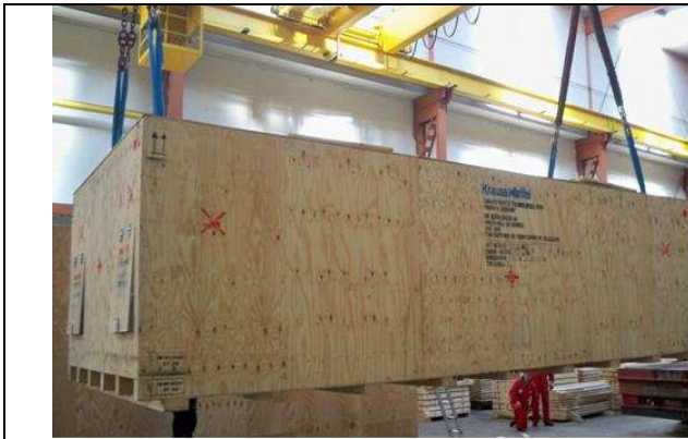
Verpakking wordt alleen "meegenomen" – aanslagpunten zijn aan de machine! / Belangrijk: kleppen aan de folie en aan de kist absoluut opnieuw afsluiten!
